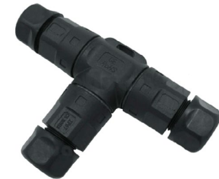
名称：防水连接插头 型号：S06 输入：最大 500V 额定电流：8A IP 等级：IP68 电缆适用直径：5-9mm
