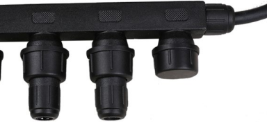
名称：防水连接插头 型号：S06 输入：最大 500V 额定电流：8A IP 等级：IP68 电缆适用直径：5-9mm
